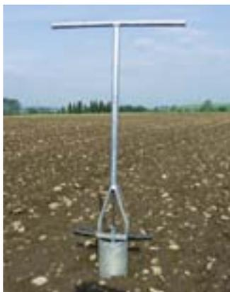
Figura 22: Aparato para extracción de tierra.
