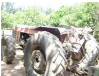
Tractor sin protección para el operador
